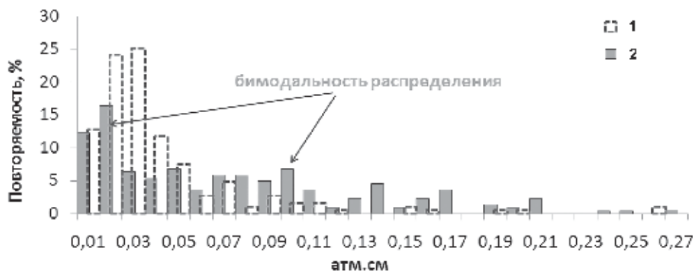
Рис. 2. Распределение величин антропогенной части содержания \Delta U в Москве (1) и Пекине (2) для осеннего периода 1992–2012 гг.
