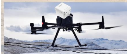
Воздушный газоанализатор Sniffer4D БПЛА DJI Matrice 300
